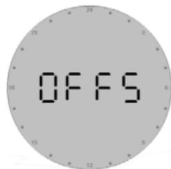
Das Thermometer zeigt z.B.  $1^{\circ}\text{C}$  mehr an, als am **devireg™ 550** eingestellt ist,
